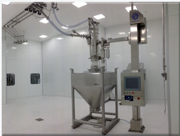
IMPIANTO AUTOMATICO DI DISPENSING MATERIE PRIME
